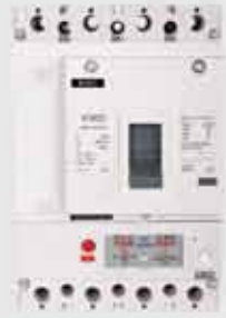
Kaçak Akımlı Kompakt Şalter, VMR In : 50A - 250A Icu : 25kA, 35kA Idn : 100mA, 300mA, 500mA
